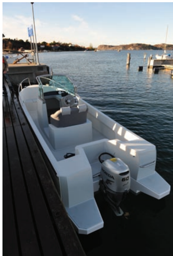
Höga skrovsidor ger hög säkerhet. Bild: Joacim Söderberg, Honda Nordic, (PE)
